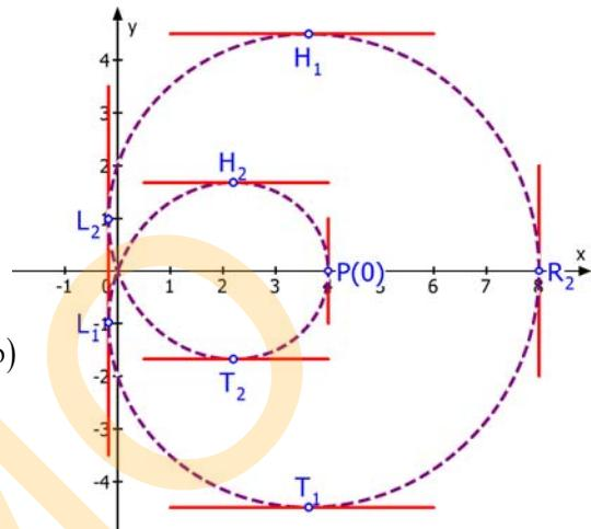
**Notwendige Bedingung für Extremwerte in y-Richtung:**  $\dot{y}(\varphi) = 0 \quad \text{für } \varphi \in [0 ; 2\pi[$
